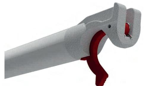
Las garras se cierran automáticamente. Para quitarlo, presione el pestillo y levante la barra. Comprobar siempre el funcionamiento de las garras. Nunca utilice herramientas al retirar. Si esto no funciona, vuelva a comprobar si el andamio está nivelado.
